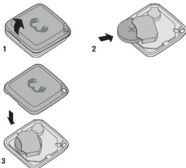
1. Ouvrez avec précaution la rainure du couvercle de la batterie à deux mains ou avec un petit outil.
